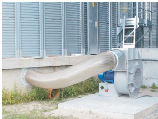
Rys. 1. Wentylator osiowy do nadmuchu powietrza w silosie płaskodennym zasilany silnikiem elektrycznym Fig. 1. An axial fan assisting airflow in a flat-bottom silos powered by an electric engine
