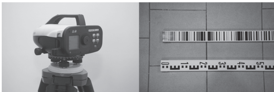
Rysunek 1. Niwelator Leica Sprinter 150M i łąty GSS113 o długości 3m Figure 1. Leica Sprinter 150M level and 3m-length GSS113 leveling rods
