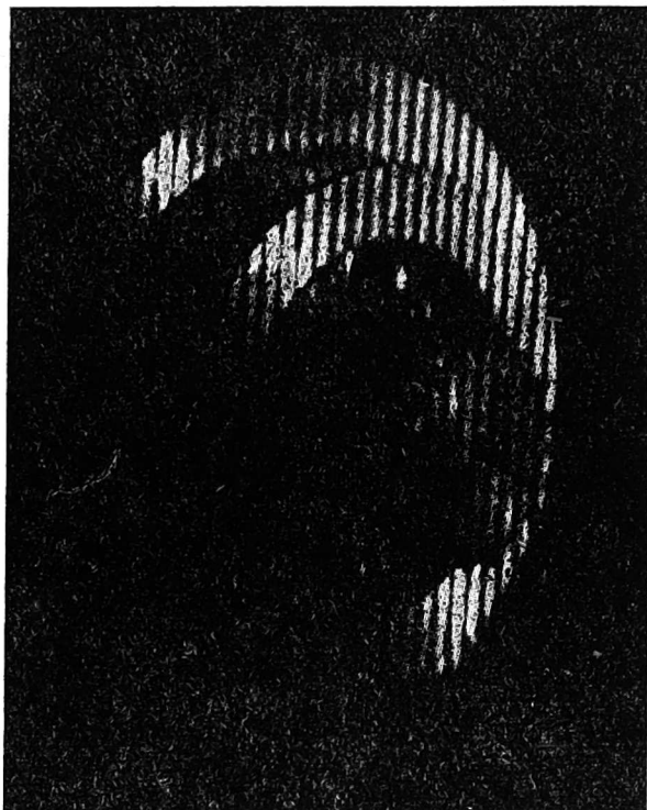
Rys. 7. Interferogram holograficzny przedmiotu wykonany metodą podwójnej ekspozycji — pomiędzy pierwszą i drugą ekspozycją nastąpił obrót przedmiotu względem osi prostopadłej do kierunku obserwacji [IGiK]
