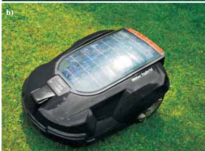
Rys. 1. Kosiarka automatyczna: a) akumulatorowa firmy Stiga, b) hybrydowa [1] Fig. 1. Automatic lawn mower: a) rechargeable Stiga, b) hybrid [1]
