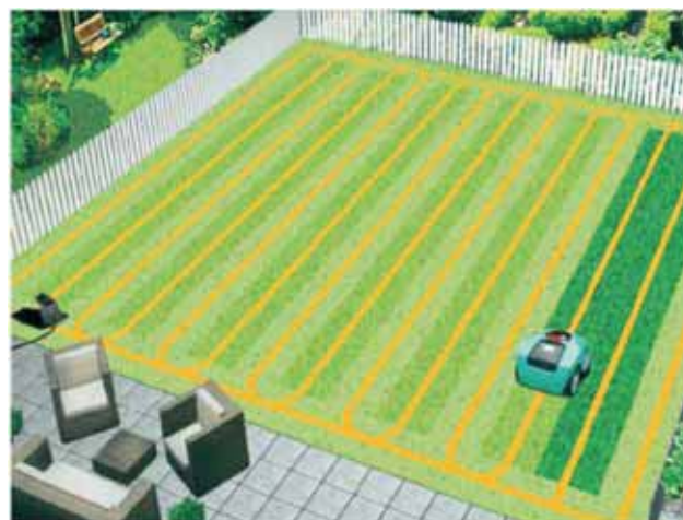
Rys. 8. Schemat poruszania się kosiarki automatycznej wyposażonej w funkcję zapamiętywania obszaru już skoszonego [6]
