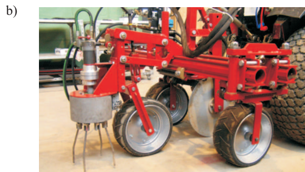
Rys. 1. Pielnik o cykloidalnym ruchu elementu roboczego: a) istota działania, b) widok sekcji pielącej [10, 20]
