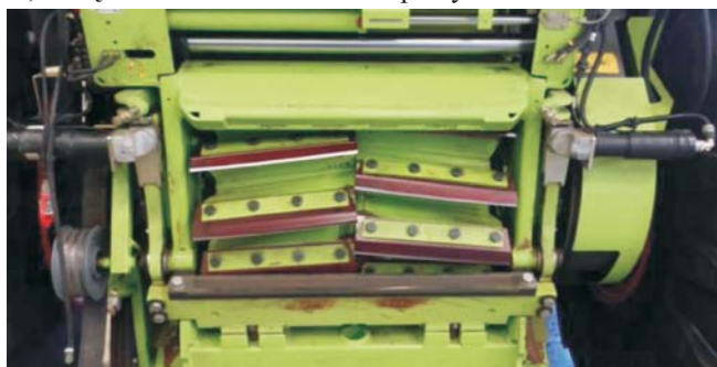
Rys. 2. Bęben tnący wraz ze stalnicą z systemem automatycznej regulacji
