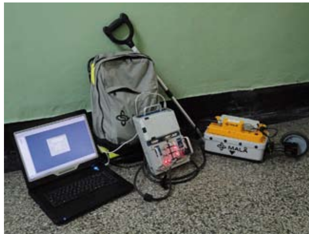
Ryc. 1. Aparatura pomiarowa (od lewej: laptop/rejestrator, jednostka centralna, antena ekranowana 800 MHz z wyzwalaczem odległościowym).
