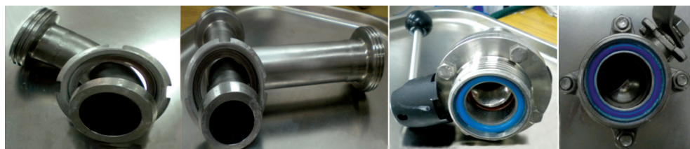
Rys. 1. Elementy instalacji przesyłowej poddawane procesowi brudzenia i mycia
