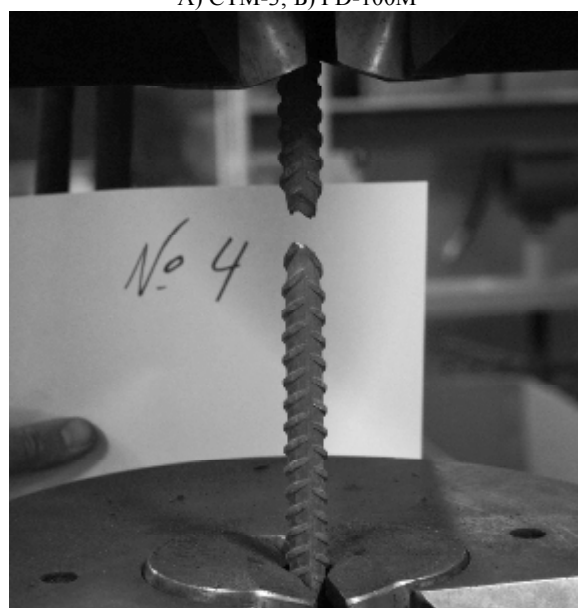
Рис. 10.. Испытания арматурного стержня в стадии поставки
