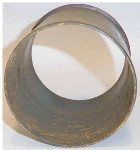
Źródło: opracowanie własne / Source: own work Rys. 5. Widok pobocznic tulei wykonanej z materiału iglidur® G Fig. 5 View of the peripheral surface of outlet tube made from iglidur® G
