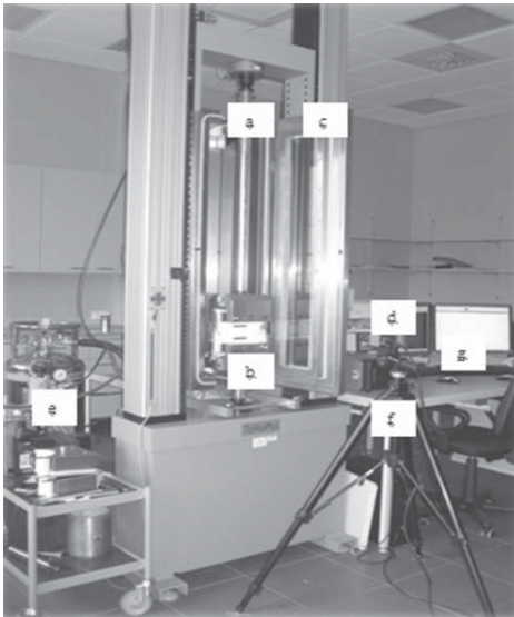
Rys. 4. Stanowisko do wyznaczania wytrzymałości na rozciąganie [Stępień 2014]
