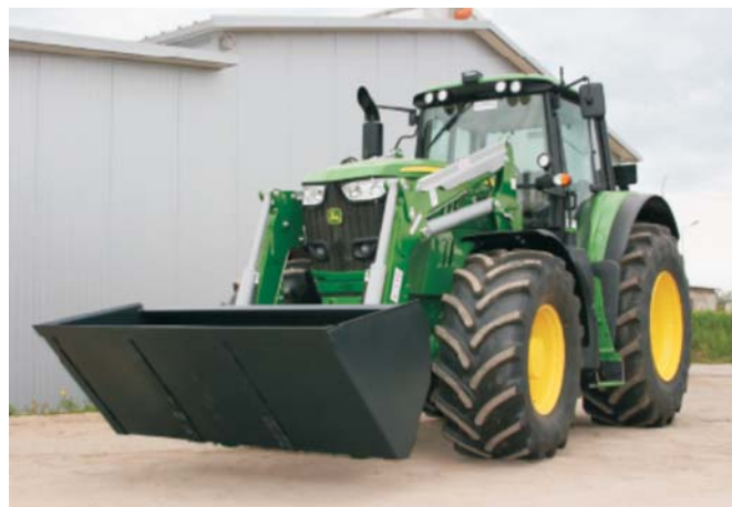
Rys. 1. Innowacyjny ładowacz Ł-110, zamontowany na ciągniku John Deere serii 6M [2]
