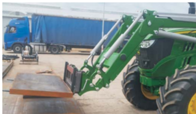
Rys. 7. Testy udźwigu prototypu ładowacza Ł-110 i dokładności wskazań systemu wagowego [1]
