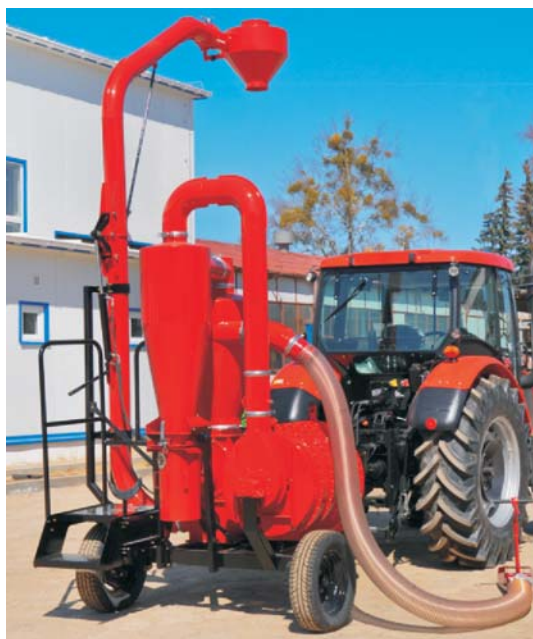
Rys. 1. Widok ogólny pięciostopniowego przenośnika pneumatycznego
