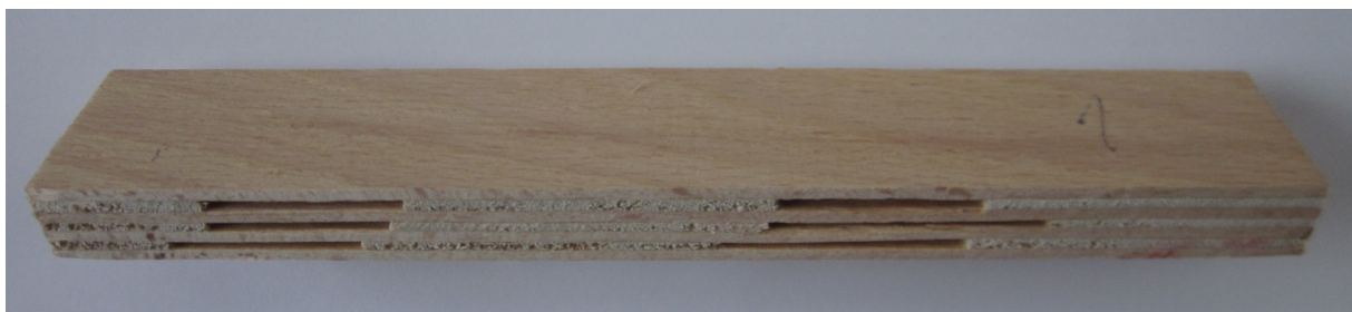
Рис. 2 Образец облегченной фанеры для определения плотности
