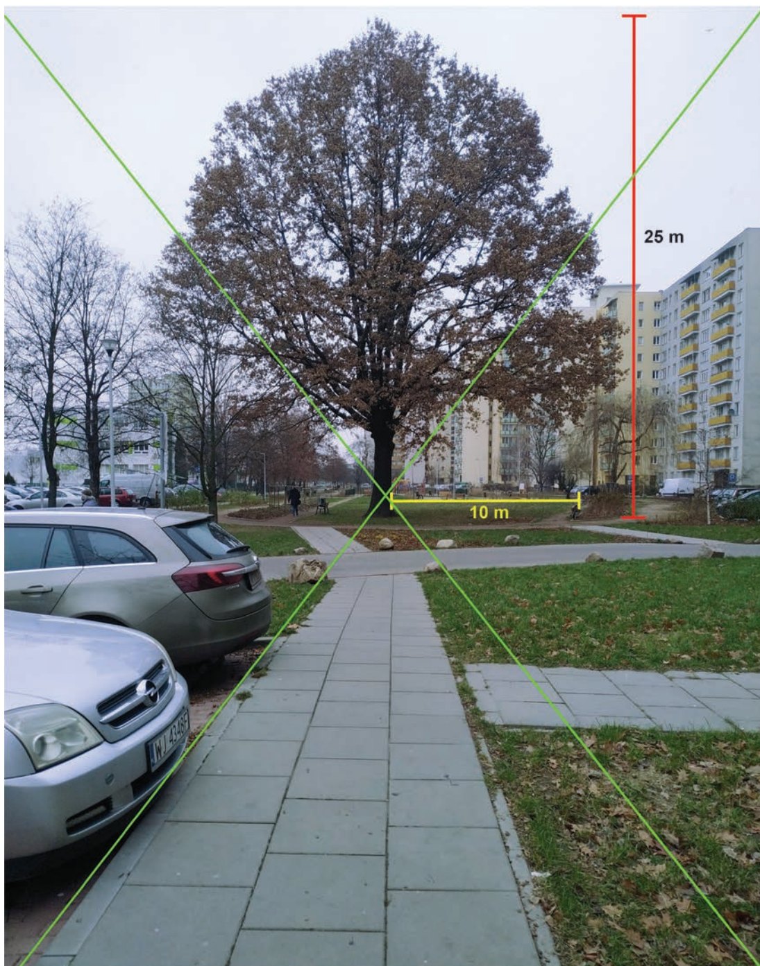
Ryc. 7. Prawidłowy pomiar dużego drzewa ( Quercus robur ). Wysokość drzewa i odległość pozioma nie podlegają zniekształceniu perspektywicznemu
