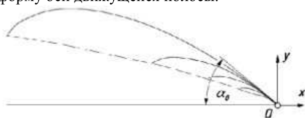
Рис. 9. Изменение оси гибкой полосы по мере ее продвижения по плоскости. \varepsilon=30^\circ , f=1 , \alpha_0=40^\circ
