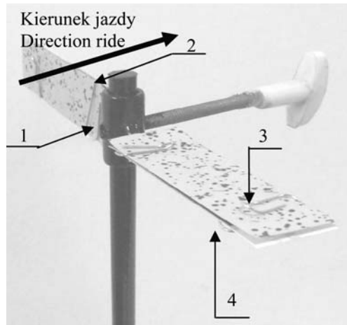
Rys. 2. Zdjęcie sztucznej rośliny: 1 – pionowy najazdowy ( A_{nj} ), 2 – pionowy odjazdowy ( A_{oj} ), 3 – poziomy górny ( A_{pog} ), 4 – poziomy dolny ( A_{pod} ) Fig. 2. Artificial plant photo: 1 – vertical approach ( A_{nj} ), 2 – vertical leaving ( A_{oj} ), 3 – upper vertical level ( A_{pog} ), 4 – lower vertical level ( A_{pod} )
