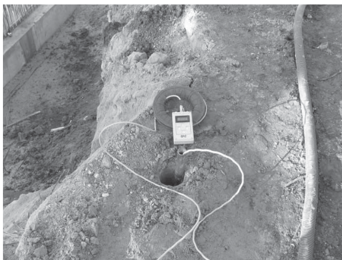
RYSUNEK 5. Wykonywanie badania przepuszczalności systemem BAT w przesłonie FIGURE 5. The view of BAT system during permeability test in cut-off wall
