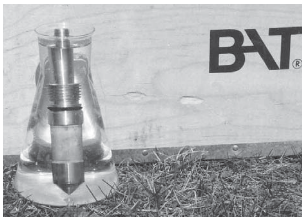
RYSUNEK 3. Schemat i widok końcówki filtrującej sondy BAT FIGURE 3. The scheme and view of BAT piezometer
