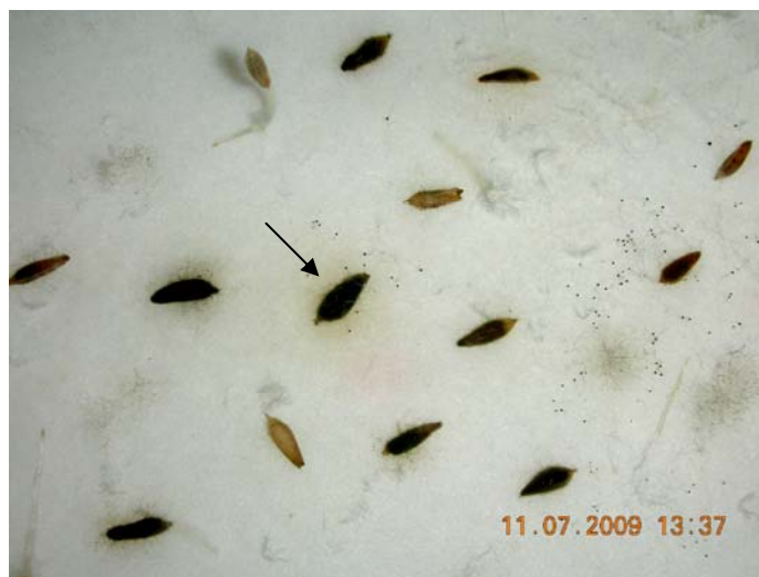
Fig. 1. Black dead lettuce seeds (marked with an arrow) in germination test in the laboratory Ryc. 1. Czarne martwe nasiona sałaty (zaznaczone strzałką) w ocenie kiełkowania w laboratorium
