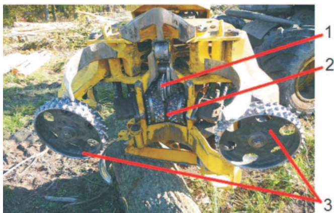
Rys. 7. Walce posuwowe w głowicy firmy John Deere: 1 - kółko pomiarowe długości sortymentu, 2 - zespół dwóch walców stałych połączonych ze sobą przekładnią zębatą, 3 - walce posuwowe ruchome
