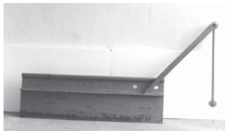
RYSUNEK 5. Źródło fali sejsmicznej w postaci stalowej belki, wykonane w ramach badań FIGURE 5. Steel beam seismic source performed for SCPT tests
