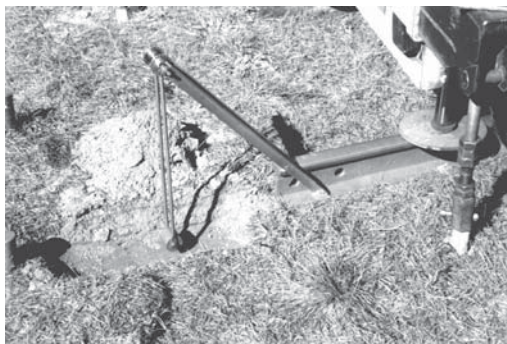
RYSUNEK 5. Źródło fali sejsmicznej w postaci stalowej belki, wykonane w ramach badań FIGURE 5. Steel beam seismic source performed for SCPT tests
