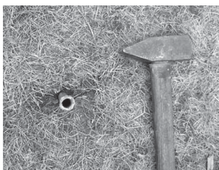
RYSUNEK 6. Źródło fali sejsmicznej w postaci metalowego „lizaka” FIGURE 6. Steel „lollypop” seismic source
