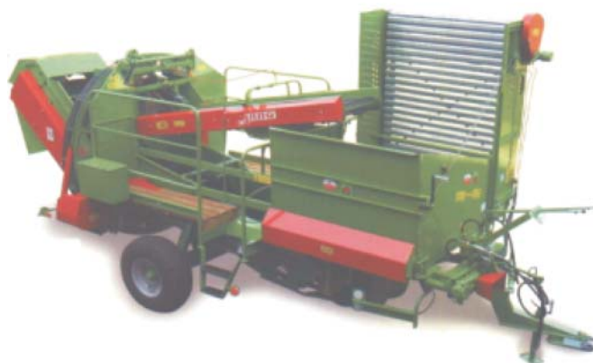
Rys. 4. Kombajn jednorzędowy Z 644 Anna
