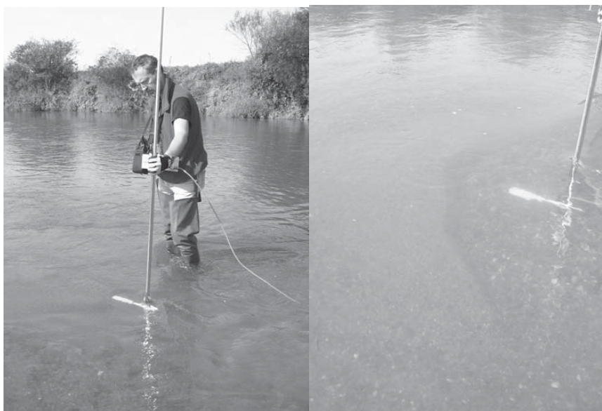
RYSUNEK 7. Pomiar prędkości w rejonie wydmy piaszczysto-żwirowej – rzeka Raba
