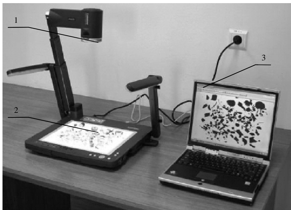
Fot. 3. Stanowisko do pomiaru geometrii zrębków metodą analizy obrazu, 1 – kamera, 2 – podświetlany stolik z materiałem badawczym, 3 – komputer od archiwizacji i analizy obrazów
