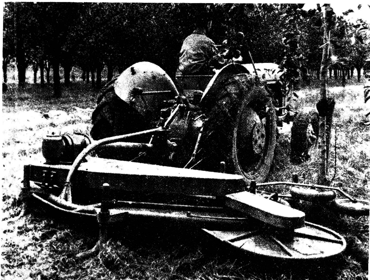
Rys. 3. Kosiarka rotacyjna do koszenia w sadach z odchylaną prawą częścią przy natrafieniu na drzewko owocowe
