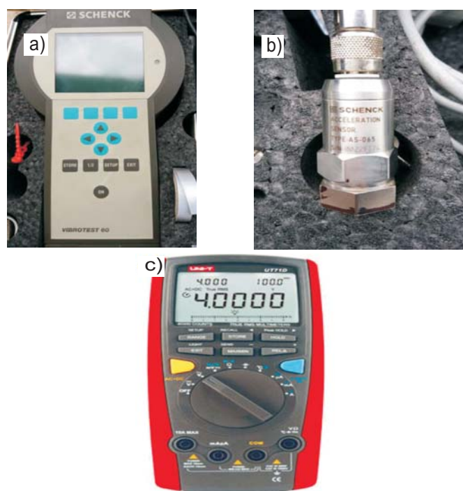
Źródło: opracowanie własne na podstawie [3, 4] / Source: own work based on [3, 4] Rys. 3. Urządzenia pomiarowe a) Vibrotest 60 służący do pomiaru drgań, b) akcelerometr będący na wyposażeniu urządzenia Vibrotest 60, c) multimetr UT71D wyposażony w funkcję pomiaru temperatury
