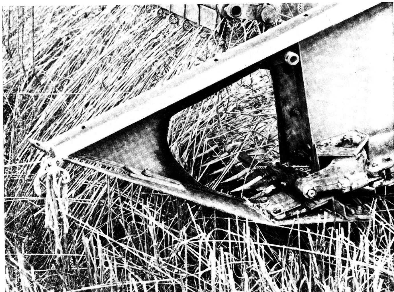
Rys. 8. Otwór z boku listwy tnącej zespołu żniwnego kombajnu KZS-3 — „Bizon”
