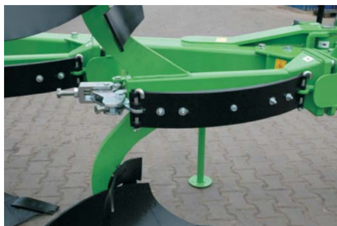
Rys. 6. Zabezpieczenie resorowe pary korpusów w pług obracalnym [8]
