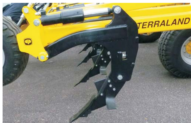
Rys. 7. Zęby głębosza z hydraulicznym zabezpieczeniem przeciążeniowym [7]
