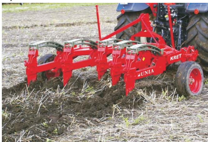
Rys. 5. Głębosz z zębami zabezpieczonymi podwójnymi resorami [13]
