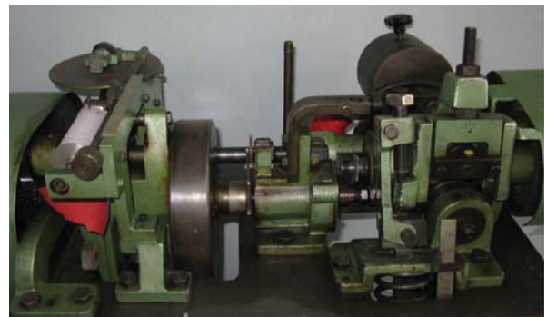
Rys. 3. Widok tribometru Amsler do badania odporności na ścieranie
