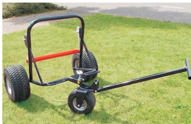
Rys. 6. Ręczne urządzenie do układania darni [8] Fig. 6. The hand-held device for laying turf [8]
