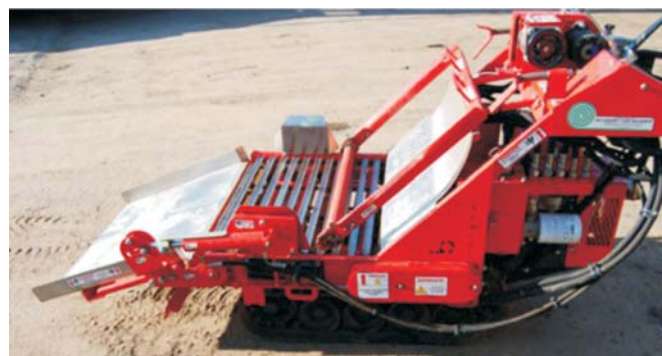
Rys. 7. Urządzenie do układania darni z napędem silnikowym i gąsienicowym układem jezdnym [9]
