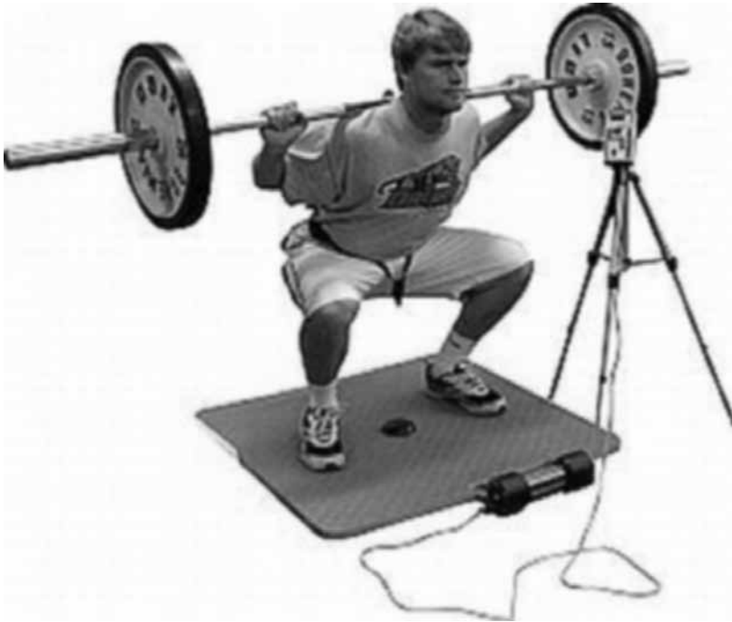
Rycina 2. Urządzenie do pomiaru czasu wykonania ruchu i długości drogi środka ciężkości sztangi (Tendo Weight Lifting Analyser)
