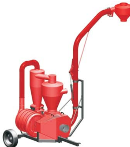
Rys. 2. Model opracowywanego przenośnika ssąco-tłoczącego [5] Fig. 2. Model of developed pneumatic conveyor [5]
