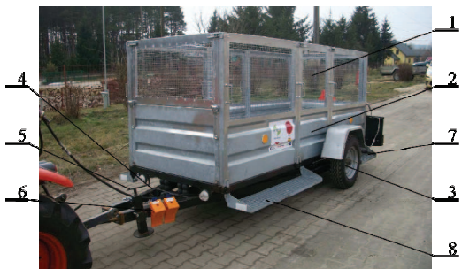
Rys. 4. Jednoosiowa przyczepa-wywrotka do transportu zrębków REM-15: 1 - górna część ażurowa burty, 2 - dolna część pełna burty, 3 - koło jezdne z błotnikiem, 4 - rama nośna z dyszlem, 5 - podpora, 6 - kliny pomocnicze, 7 - podest tylny, 8 - podest przedni
