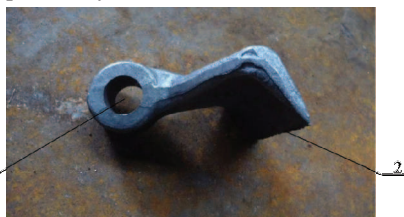
Rys. 3. Bijak rozdrabniający: 1 - piasta mocowania bijaka, 2 - krawędź tnąca
