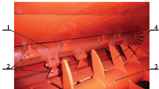
Rys. 2. Widok układu podającego i wału rozdrabniającego: 1 - wał rozdrabniający, 2 - bijaki rozdrabniające, 3 - wał podbierający, 4 - zęby podające
