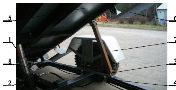
Rys. 5. Układ unoszenia skrzyni ładunkowej przyczepy-wywrotki REM-15: 1 - silownik hydrauliczny, 2 - przewód hydrauliczny, 3 - wspornik zabezpieczający, 4 - rama przyczepy, 5 - spód skrzyni ładunkowej, 6 - podest przedni, 7 - koło jezdne z błotnikiem, 8 - wiązka przewodów elektrycznych oświetlenia przyczepy-wywrotki
