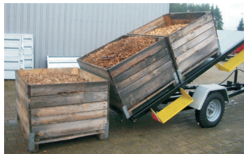
Rys. 9. Przyczepa REM-15 w trakcie rozładunku skrzynio-palet
