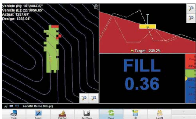
Rys. 6. Ekran programu do sterowania spycharką, przedstawiający jej położenie na planie terenu i wyświetlający informacje o zakresie wykonywanej pracy (FILL = nagarnij więcej ziemi) z wygodną skalą i suwakiem w kształcie żółtego trójkąta [19]
