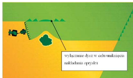
Rys. 5. Zasada prowadzenia oprysku precyzyjnego, sterowanego w oparciu o system GPS [9] Fig. 5. The role of precise spraying performing with the use of GPS system [9]
