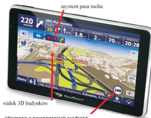
Rys. 2. Odbiornik do nawigacji samochodowej z mapą z budynkami w widoku 3D (na podstawie [16])
