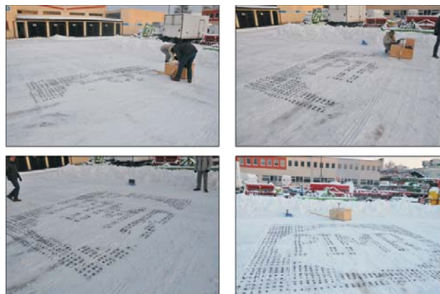
Rys. 8. Etapy wysiewania logo PIMR za pomocą modelowego siewnika precyzyjnego, sterowanego przez GPS [2]
