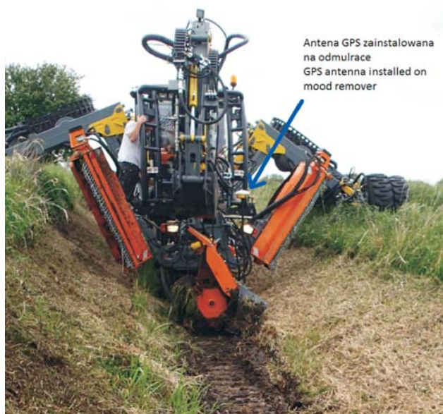
Rys. 9. Model koncepcyjny nowego urządzenia wielozadaniowego do regeneracyjnego kształtowania otwartych cieków wodnych, opracowanego w PIMR*
