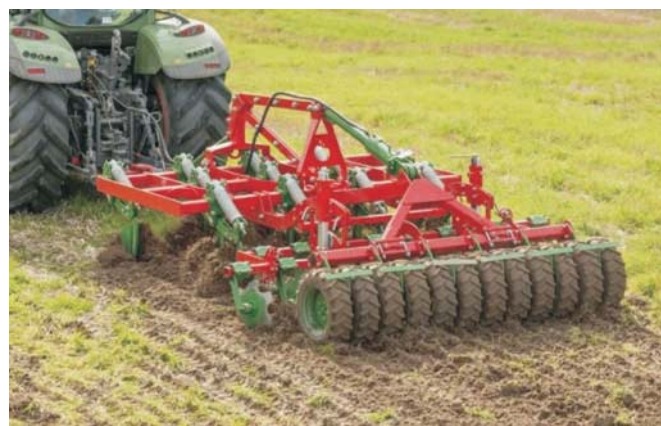
Rys. 5. Uprawa bezorkowa agregatem na bazie kultywatora ciężkiego [10] Fig. 5. No-tillage cultivation based on heavy cultivator unit [10]
