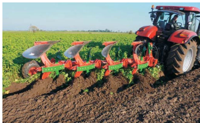
Rys. 2. Orka pługiem obracalnym Fig. 2. Plowing with reversible plow
