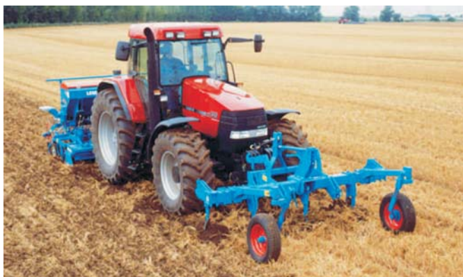
Rys. 8. Uprawa bezorkowa kultywatozem przednim i agregatem uprawowo-siewnym na bazie brony wirnikowej [9]
