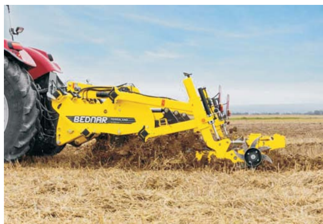
Rys. 6. Uprawa bezorkowa agregatem na bazie głębosza [6] Fig. 6. No-tillage cultivation based on subsoiler [6]
