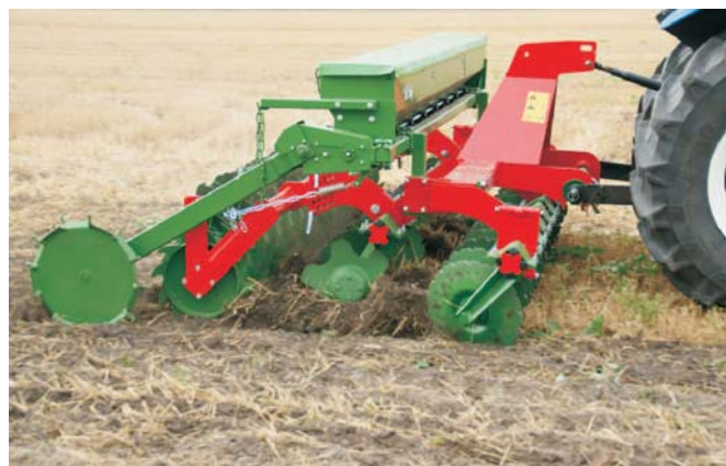
Rys. 1. Uprawa ścierniska broną talerzową i siew poplonu Fig. 1. Stubble cultivation with disc harrow and aftercrop sowing
