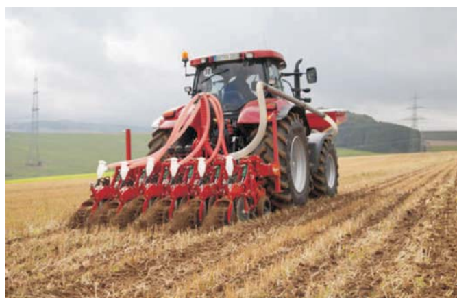
Rys. 12. Uprawa pasowa i nawożenie wglębne [8] Fig. 12. Strip-till and subsoil fertilization [8]
