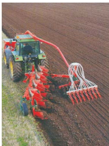
Rys. 4. Orka połączona z doprawieniem gleby i siewem [8] Fig. 4. Plowing combined with soil seasoning and sowing [8]
