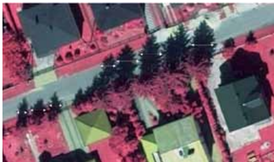
Ryc. 23. Kompozycja barwna uzyskana z kanałów G, R oraz IR. Pokazano sposób pomiaru szerokości koron z wykorzystaniem cienia rzucanego przez drzewa. Metoda może być wykorzystana tylko do drzew wolnostojących, nie w zadrzewieniach zwartych (Będkowski 2014, zdjęcie z archiwum KULGiEL SGGW) Fig. 23. Image composite made with use of G, R and IR bands. There is shown how to use a shadow casted by tree to assess it's crown diameter. This approach can be applied to single tree growing apart from other trees only, not to trees in forest stands
