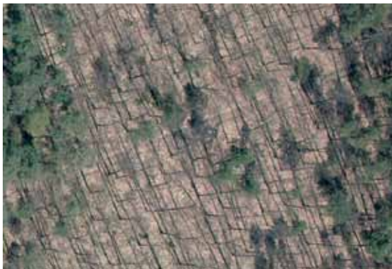
Ryc. 5. Fragment zdjęcia lasu wykonanego w okresie przedwiośnia. Widoczne są korony sosen, natomiast korony drzew liściastych są trudne do rozpoznania. Interpretację obrazu dodatkowo utrudniają wyraźne cienie pni drzew, bowiem zdjęcie wykonano przy pełnym oświetleniu słonecznym (archiwum KULGiEL SGGW)
