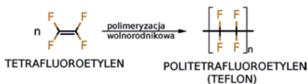
Ryc. 4. Schemat produkcji teflonu.
