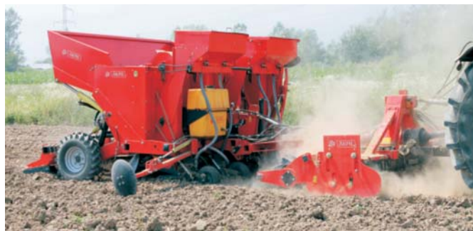
Rys. 4. Wieloczynnościowy agregat do sadzenia ziemniaków podczas pracy
