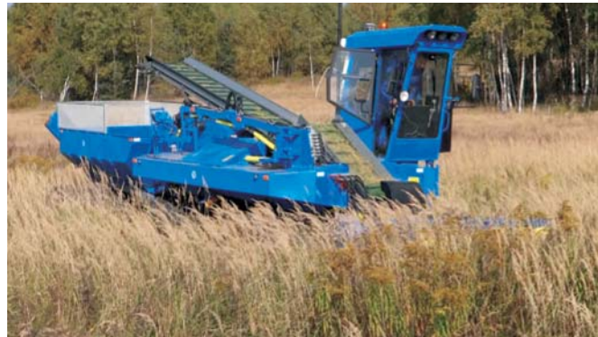
Rys. 5. Wielomodułowa samobieżna maszyna do ochrony obszarów wodno-błotnych wg wynalazków PIMR
