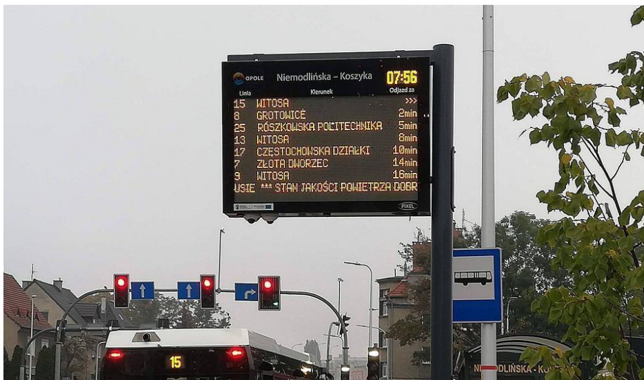
Figure 3. A variable message board at the bus stop in Opole Rysunek. 3. Zmienna tablica ogłoszeń na przystanku autobusowym w Opolu Source: [maj and usz 2020].
