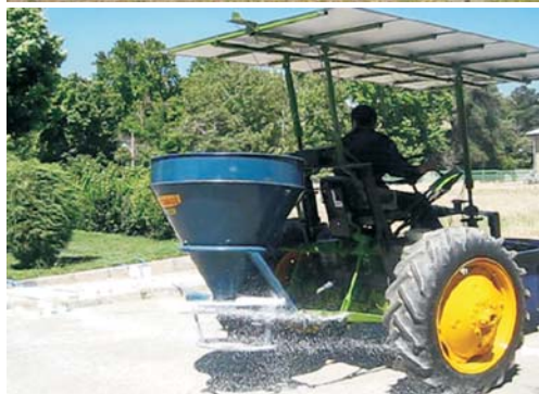
Rys. 11. Model ciągnika elektrycznego zbudowany w ramach projektu SAPHT [5] Fig. 11. Model of electric tractor developed within SAPHT project [5]
