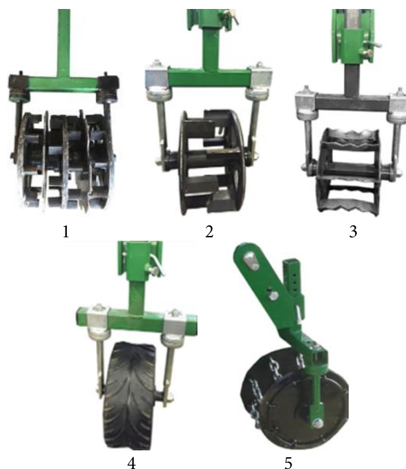
Rys. 3. Wały sekcji roboczych agregatów z serii Strip Hawk Easy firmy Moretto Officine Meccaniche S.A.S. [17]: 1 – Cambridge, 2 – do kruszenia dużych brył, 3 – zwykły do kruszenia brył, 4 – oponowy, 5 – łańcuchowy
