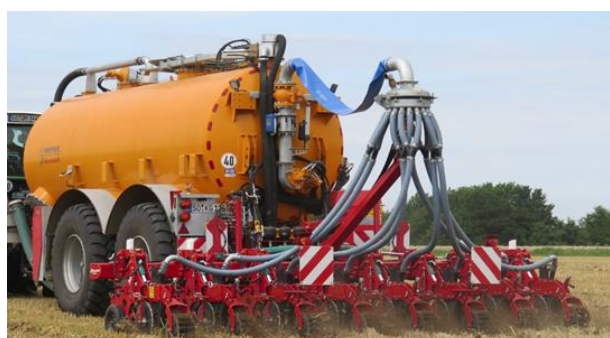
Rys. 2. Agregat Kultistrip wyposażony w aplikator do nawożenia gnojowicą [27]
