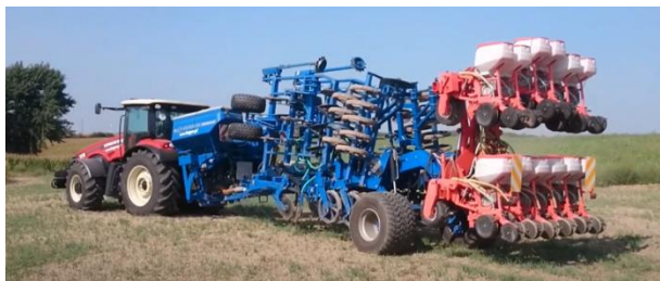
Rys. 11. Agregat na bazie Master 600 do pasowej uprawy gleby, nawożenia i siewu precyzyjnego rzepaku [36]
