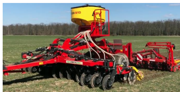
Rys. 10. Agregat na bazie Agro Strip Till Liner z aplikatorem nawozów PS 800 M1D podczas siewu nasion buraków cukrowych [34]
