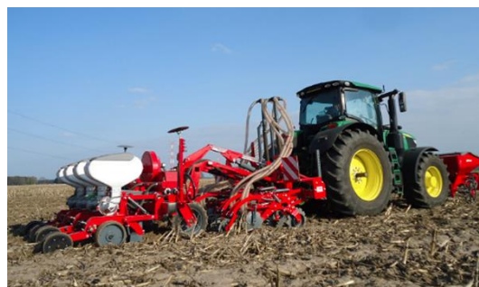
Rys. 1. Technologia uprawy pasowej, nawożenia i precyzyjnego siewu nasion na bazie agregatu HAWK 3 i pozostałych maszyn produkowanych przez Unia Sp. z o.o. [25]
