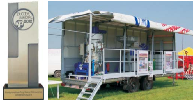
Rys. 6. Mobilny zakład tłoczenia oleju roślinnego i jego przeróbki na biopaliwo
