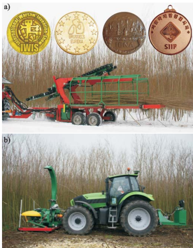
Rys. 1. Maszyny do zbioru dwufazowego (a) oraz jednofazowego (b) wierzby krzewiastej według wynalazku PIMR Fig. 1. Machines for the two-phase harvest (a) and one-phase harvest (b) of basket willow according to the invention of PIMR
