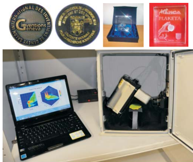
Rys. 8. Sposób pomiaru oprysku agrotechnicznego metodą luminiscencji wzbudzonej według wynalazku PIMR Fig. 8. The way of measurement of the agrotechnological spray with method of aroused luminescence according to the invention of PIMR
