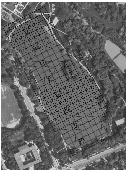
Rys. 1. Ortofotomapa Zalewu Nowohuckiego z siatką kwadratów, wydzielonymi obszarami badawczymi i punktami badawczymi
