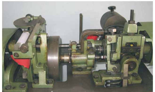
Rys. 7. Widok tribometru Amsler do badania odporności na ścieranie
