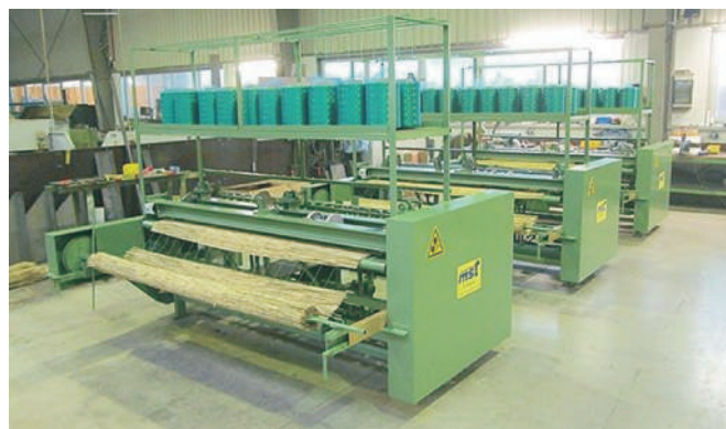
Rys. 5. Maszyny do produkcji mat wiklinowych SMM-Gama firmy MST-FASERTECHNIK [11] Fig. 5. Machines for the production of SMM-Gama wicker mats by MST-FASERTECHNIK [11]
