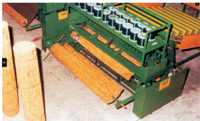
Rys. 6. Produkcja mat wiklinowych na maszynie SMM-Gama firmy MST-FASERTECHNIK [11]
