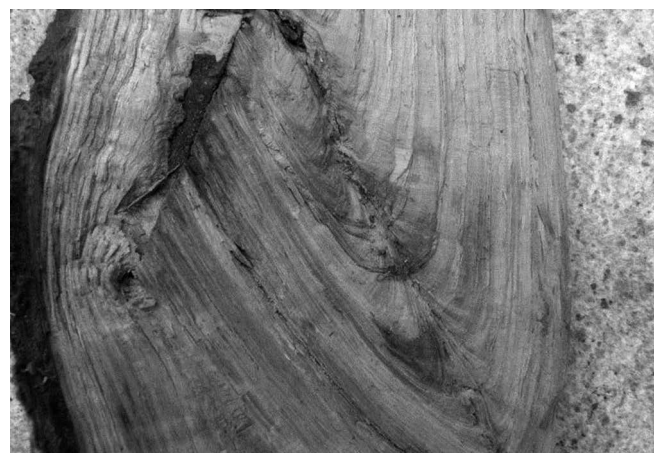
Rycina 4. Sęk z zakorkiem, elementami infekcji oraz zdrową tkanką drzewną w okolicach sęka. Sęk po gałęzi odciętej ukośnie.
