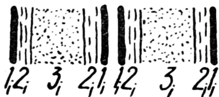
Ryc. 1. Schemat budowy ścianki komórkowej: 1 — substancja międzykomórkowa, 2 — błona pierwotna, 3 — błona wtórna (wg Frey-Wysslinga, 9),
