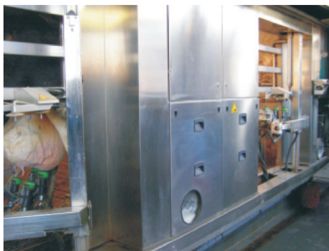
Rys. 3. Dój krów na kilku stanowiskach robota udojowego Mlone wiąże się z wykorzystaniem złożonych układów sterujących
