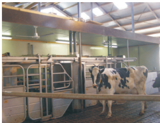
Rys. 2. Zestaw dwóch stanowisk udojowych robota z miejscem na trzecie stanowisko
