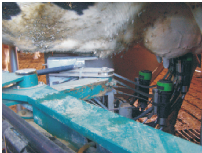
Rys. 1. Etap automatycznego zakładania kubków udojowych na stanowisku udojowym robota
