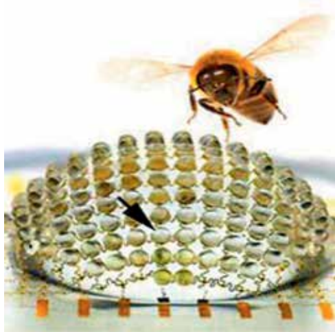
Ryc. 13. Prototyp kamery przypominającej oko złożone (wielkość kamery uwidoczono poprzez porównanie z unoszącą się nad kamerą pszczołą; fot.: University of Illinois and Beckman Institute). Kamera zbudowana jest ze 180 elastycznych soczewek (strzałka)-maleńkich „oczek”. Gdy w polu widzenia kamery pojawi się jakiś obiekt, mikrosoczewki, które na niego „patrzą”, wytwarzają mały obraz tego obiektu, a leżące pod nimi fotodiody generują prąd (zmienione za http://www.thehindu.com/sci-tech/technology/camera-with-compound-eyelike-lenses/... ).
