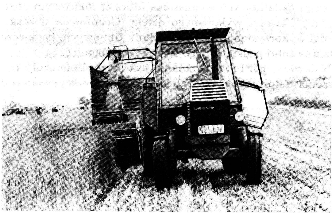
Rys. 5. Kadr z filmu naukowego Agregat ciągnika Ursus C-385 z sieczkarnią polową przy zbiorze żyta na kiszonkę
